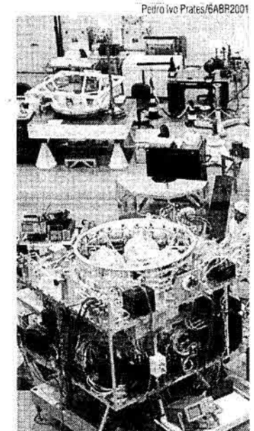
O satélite CBERS-2, durante a fase de integração e testes no laboratório do Inpe em São José
